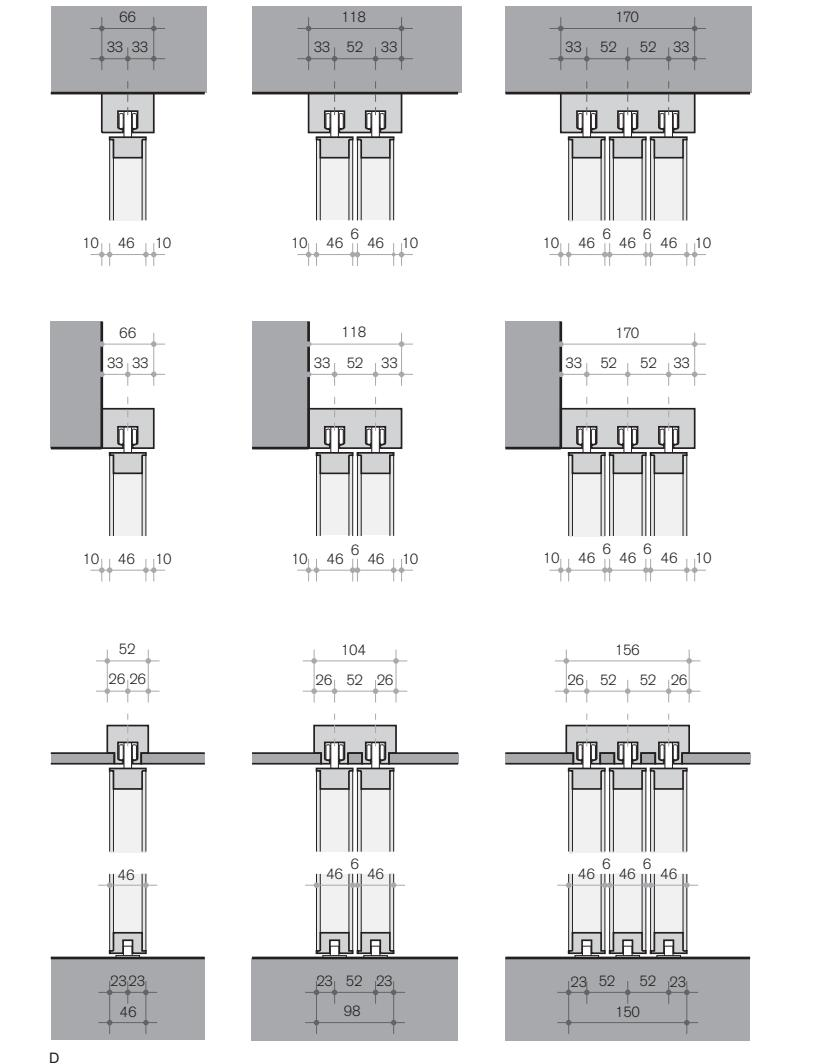
**D.** sezione a una, due, tre ante con binario esterno, a muro e incassato
